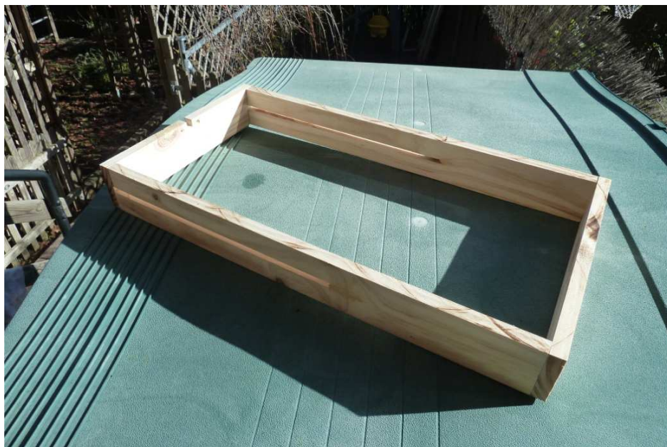
Tablillas 664 x 80 x 18 mm (ranuras 400 x 8 mm al centro desde extremo)
