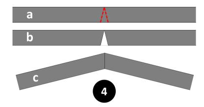
4) Para conseguir el ángulo φ entre los segmentos L1 y L2, se marca un ángulo de 180° - φ y se recorta sin llegar hasta el final, de forma que la propia pared del tubo sirva de bisagra y le de solidez. Posteriormente se soldará la unión.
